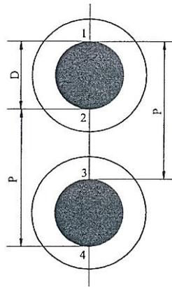
Fig.9.2. Inkjet nozzle parameters
