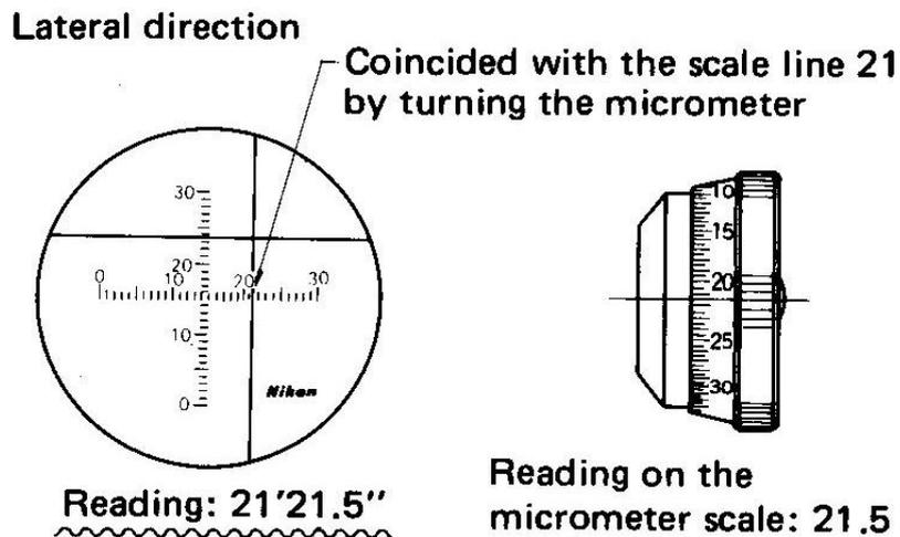
Fig.10.2. Micrometer scale
