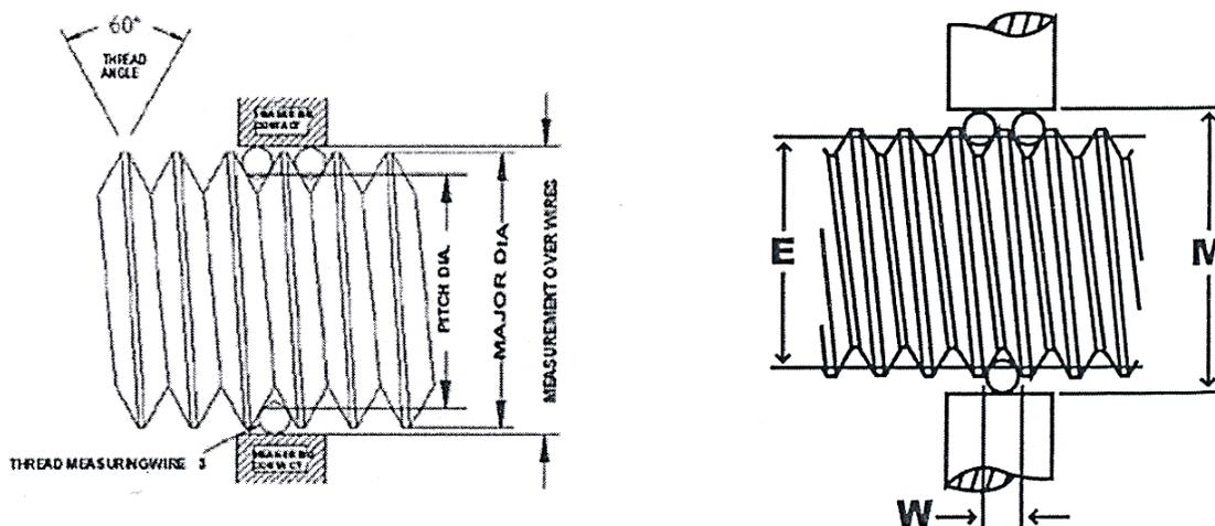
Fig. 11.2. Screw thread parameters
