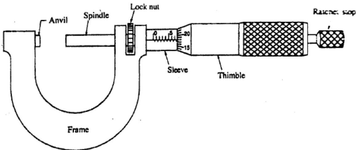
Fig. 2 Micrometer
