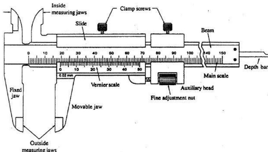
Fig. 3 Vernier caliper
